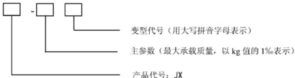
示例：最大承载质量为10 000 kg的间隙仪，型号表示为：JX-10。
