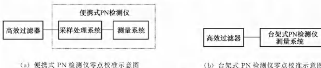
图 2 零点校准示意图
